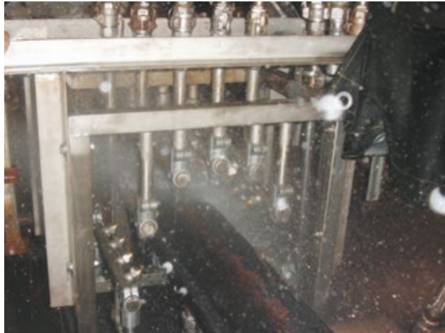
TH-Profil im Durchlauf durch die neue, flexibel steuerbare Wasserabspritzeinheit.
