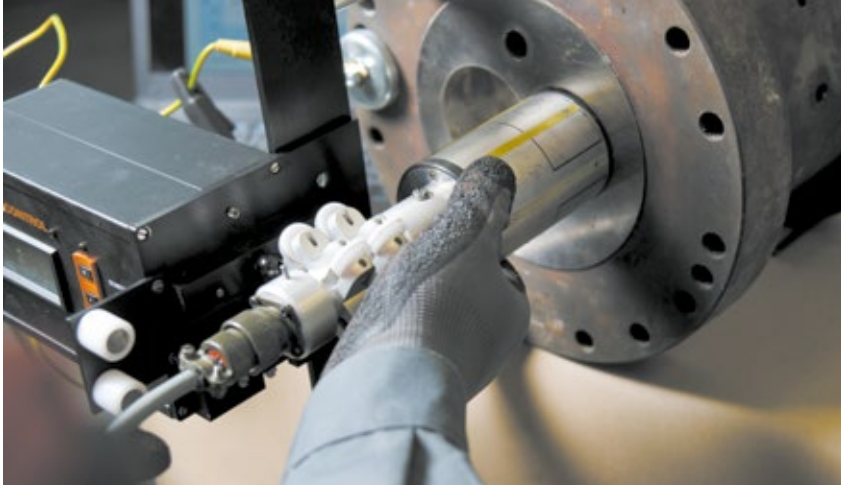
Verschleißmessung der Gehäusebohrungen an einem gleichläufigen Doppelwellenextruder.
